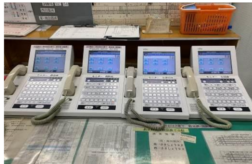
遠隔制御装置（左側から救急波・消防波・主運用波・全国波）
