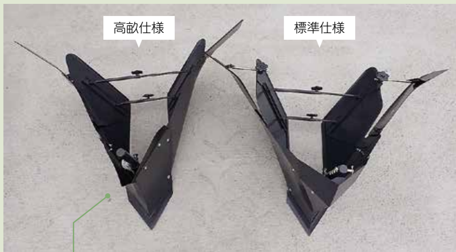
高畝仕様は全長が長く、V字の形状が異なる。
