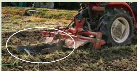
畝立て機はトラクターのロータリーのさらに後部に装着
