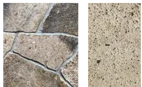
エントランスの扉には丹波鉄平石(左)、土間には丹波三和土(右)を使用した。
